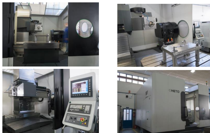
Figura 27. Máquina de furações profundas (CHETO MT1500) utilizada pela Farmi.
